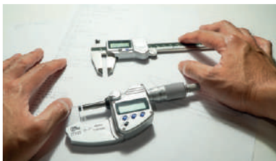
2. ábra – Digitális mérőműszerek: tolmérő és mikrométer
