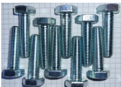
5. ábra – A csavar vastagságának közvetlen mérése többszörözéssel
