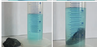
8. ábra – Szabálytalan szilárd testek térfogatának mérése
