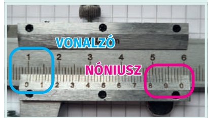
6. ábra – Olvasd le a képen látható tolómérő által mért értéket!
